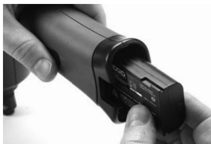
Figura 6 – Extracción e instalación de la batería
