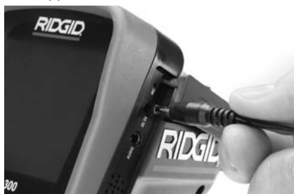
Figure 7 – Alimentation sur secteur
