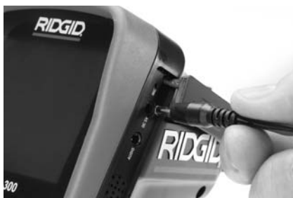
Figura 7 – Alimentación eléctrica del aparato
