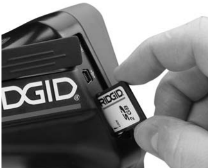
Figura 10 – Introducción de la tarjeta SD en el costado izquierdo del visualizador
